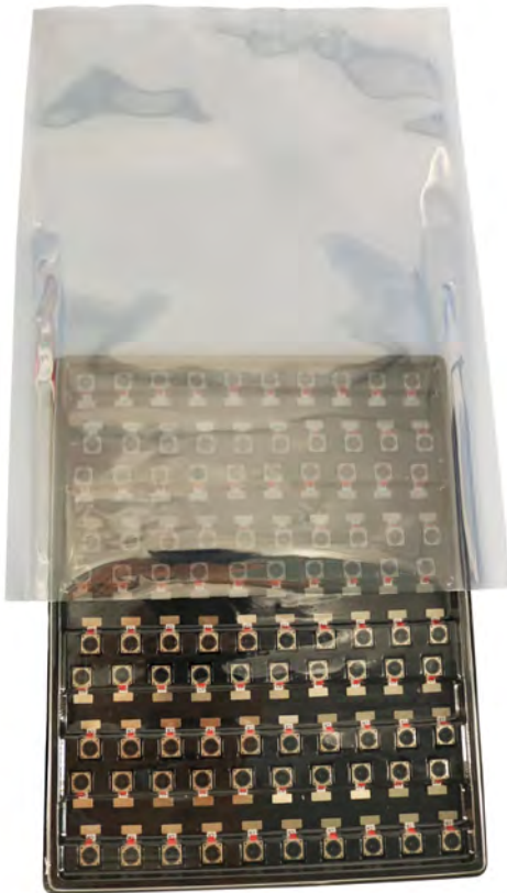
Posizionare il vassoio nella busta antistatica
